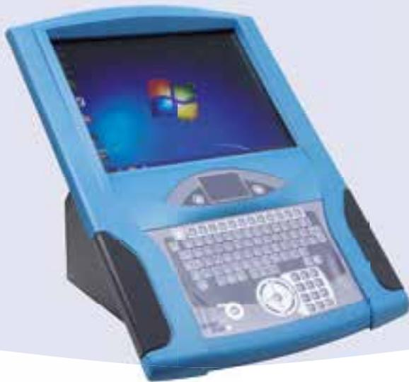
Das Color Computer System EX ist ein für Ex-Zone 2 zugelassener Computer zum sicheren Einsatz am Arbeitsplatz und in Mischräumen. Der Computer ist staubbeständig und einfach zu reinigen. Die Hardware ist für den Gebrauch der ICRIS-Software optimiert. Bringen Sie vorab in Erfahrung, welche Ex-Zonen-Zulassung in Ihrem Land oder Ihrer Region erforderlich ist, um sicherzustellen, dass Sie die Anforderungen der örtlichen Gesetzgebung erfüllen!
