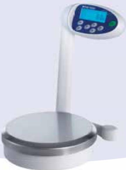
Für exakte Messungen mit einer Genauigkeit bis 0,1 Gramm steht Ihnen die Mettler 7,1-kg-Waage zur Verfügung. Dieses Messinstrument ist autonom, aber auch in Kombination mit dem Color Computer und der ICRIS-Software einsetzbar.
