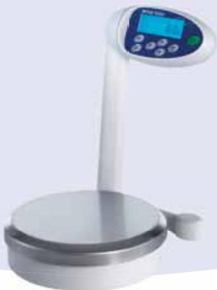
La balance Mettler 7,1 kg pèse avec une précision de 0,1 gramme. Cet instrument de mesure peut s'utiliser de manière autonome, mais également en étant connecté à l'ordinateur Couleurs et au logiciel ICRIS.
