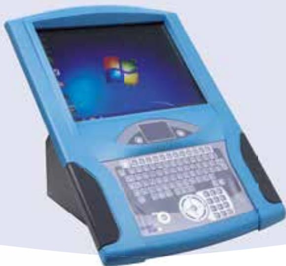
L'ordinateur Couleurs System EX est agréé pour Zone 2 ATEX et peut donc s'utiliser en toute sécurité dans les ateliers de peinture et les salles de mélange. L'ordinateur est protégé contre la poussière et se nettoie facilement. Le hardware est optimisé pour l'utilisation du logiciel ICRIS. Vérifiez préalablement le niveau de protection imposé dans votre pays ou dans votre région afin de vous assurer que cet équipement est conforme à la réglementation en vigueur !
